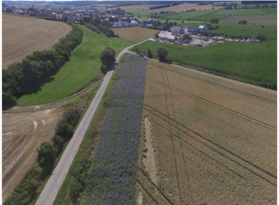
noch blüht der Grünstreifen lila: Erstbegrünung einer begrünten Ablaufmulde, der ausufernde Trockengraben ist zwischen Grünstreifen und Straße
