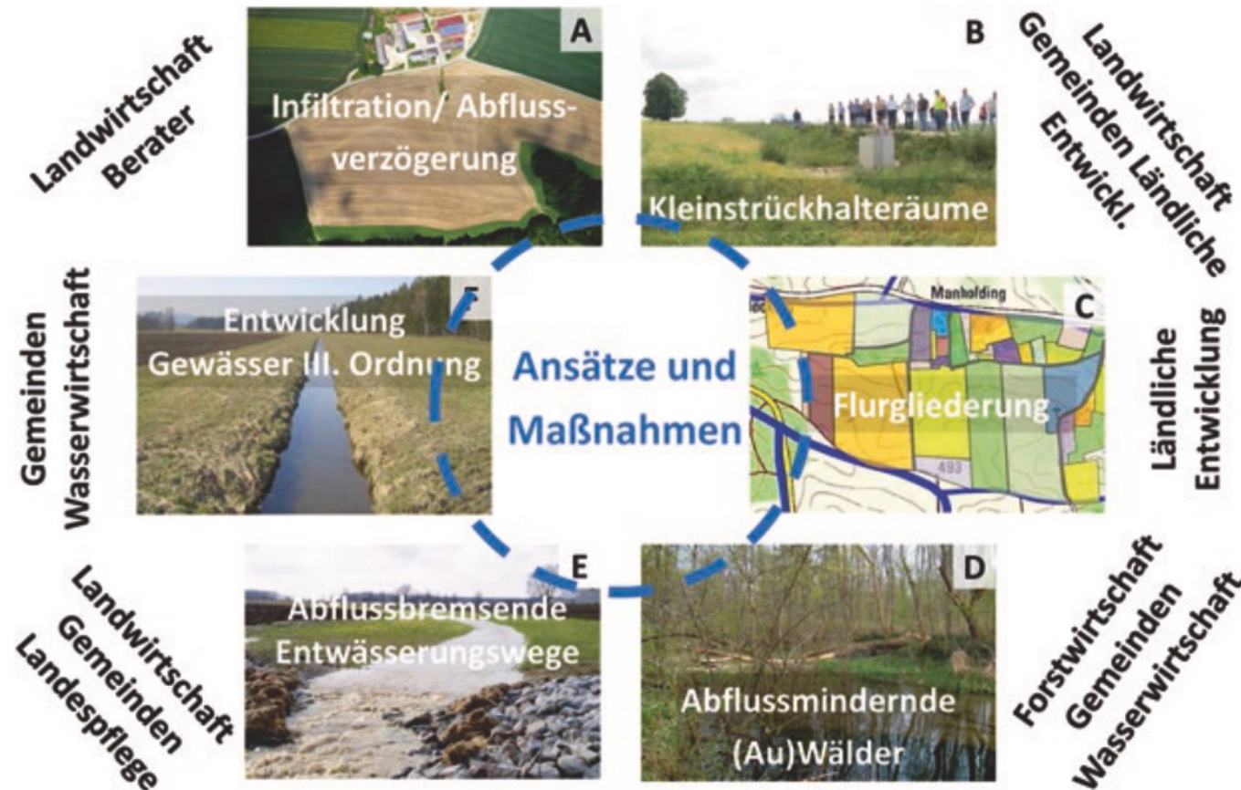
■ Abb. 2.5 Übersicht typischer Ansätze zum Wasserrückhalt und zum Bremsen des Abflusses in der Flur (weiße Beschriftung) und Akteure (schwarze Beschriftung), deren Beitrag für eine Umsetzung der Maßnahmen unerlässlich ist (Bildquellen von A: W. Bauer (Agroluftbild), B: ► www.boden-staendig.eu , C: [35], D: Illertaler (Wikipedia), E: K. Schneider (USDA Natural Resources Conservation Service), F: [36])
