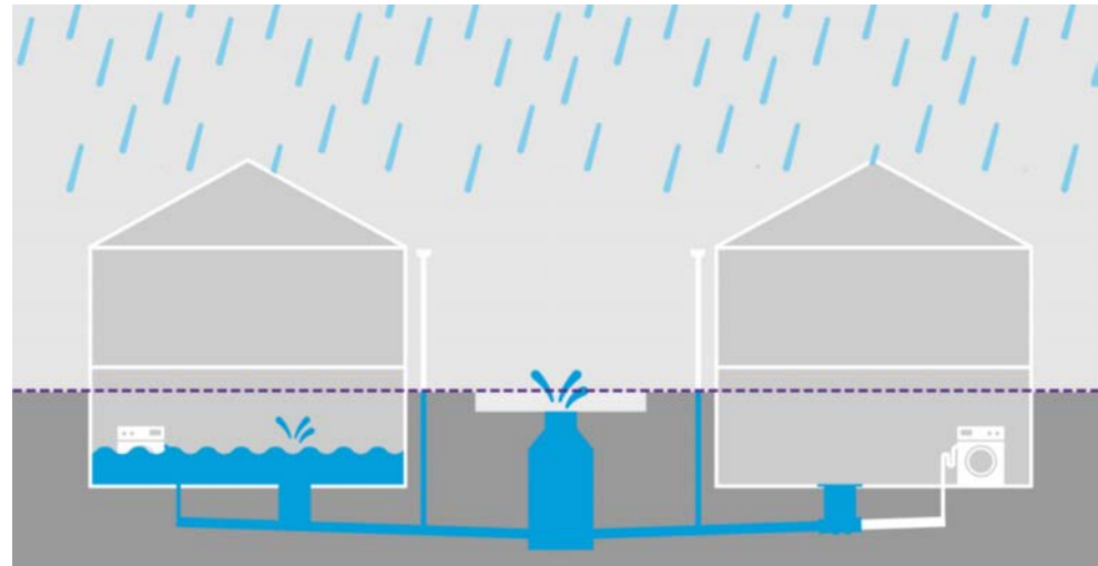
Rückstauverschluss Staufix FKA Fäkalien-Rückstauautomat
